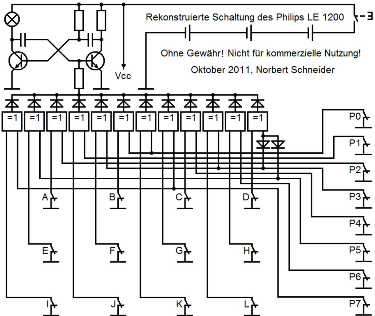
Das Schaltbild orientiert sich an der mechanischen Anordnung der Bedienelemente (Taster, Lampe und Steckkontakte) im LE 1200. Aus der Reihenfolge der nebeneinander gezeichneten Gatter kann keine Zuordnung zu den einzelnen ICs abgeleitet werden. Bei den ICs handelt es sich um drei Bausteine vom Typ SN7486 (je 4 XOR Gatter mit je 2 Eingängen). Die Spannungsversorgung der ICs ist aus Gründen der Übersichtlichkeit nur angedeutet.
